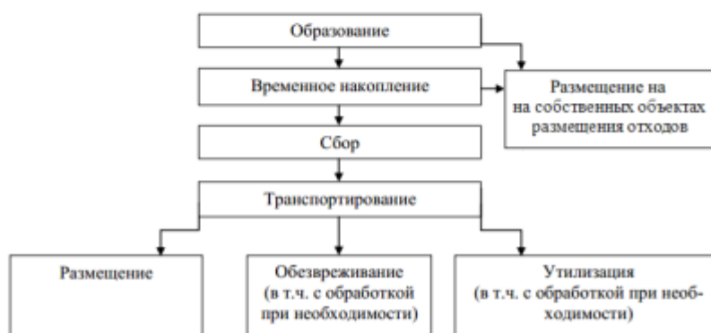
Рисунок 7.1 Технологическая схема обращения с отходами ФГУП «ГХК»
