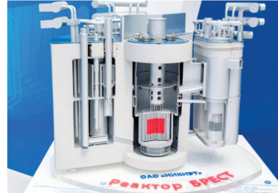
БРЕСТ-ОД-300 — «БЫСТРЫЙ» РЕАКТОР СО СВИНЦОВЫМ ТЕПЛОНОСИТЕЛЕМ, ОПЫТНО-ДЕМОНСТРАЦИОННЫЙ
